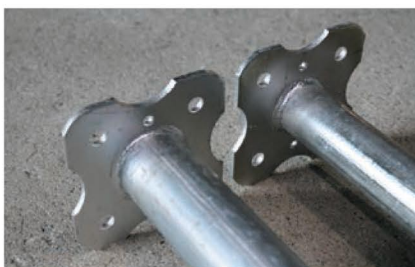
厚生労働省規格で定める刻印の表示が無いパイプサポートの例
